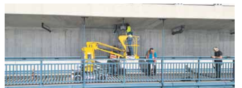
Wegen des einfahrbaren Mastes lassen sich mit der Haulotte-Bühne Star 10 auch sehr niedrige Arbeitsbereiche erreichen. Foto: HKL Baumaschinen
